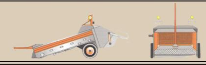
Cacamba: 750L com descarga ao nivel do solo
